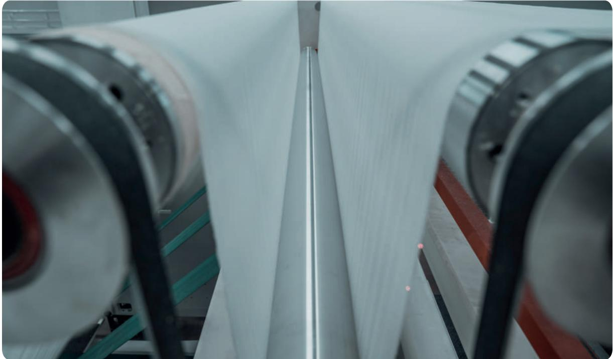
studio mirato, sono stati ottenuti significativi miglioramenti in termini di risparmio energetico ed efficienza del sistema aspirante, rallentando le velocità dei gas e riducendo le pressioni differenziali in ambienti dove la pressione gassosa è inferiore a quella atmosferica. Le linee interfogliatrici OMET offrono ora la possibilità di raggiungere una larghezza della carta fino a 5600 mm, mantenendo contemporaneamente alti livelli di velocità e qualità del prodotto finale.
