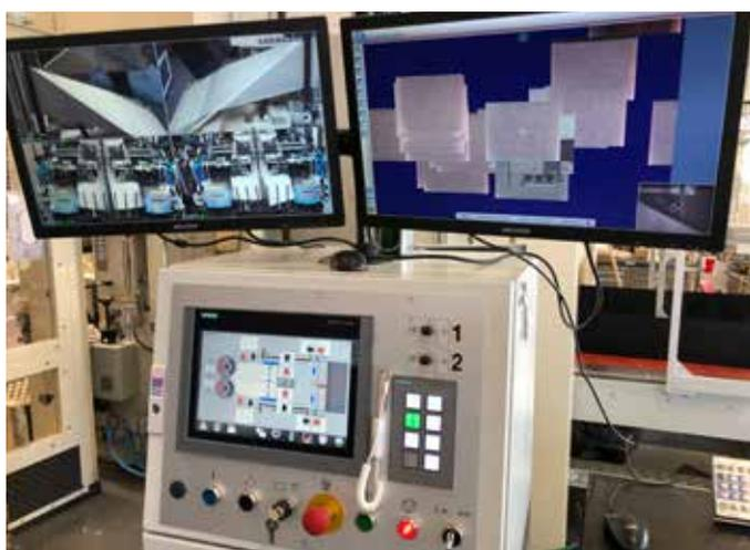
La TV840 Line TRONIC è la linea per la produzione di tovaglioli **completamente motorizzata**. È dotata infatti di servo motori su ogni asse ed è controllabile anche da remoto, sia dagli operatori che dal servizio di teleassistenza.
